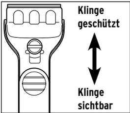
1. Schieben Sie das Oberteil zurück, so dass die eingesezte Klinge sichtbar wird. Sollte die Schraube zu fest oder zu locker sitzen, drehen Sie diese entsprechend mit einem Schraubendreher.
