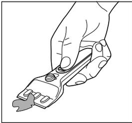
2. Entfernen Sie feste Verunreinigungen auf Glas-keramikoberflächen, indem Sie den Schaber flach über die Oberfläche führen.
