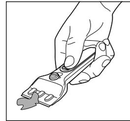
1. Repoussez la partie supérieure de façon à ce que la lame insérée soit visible. Si la vis est trop serrée ou trop lâche, tournez-la en conséquence avec un tournevis.
