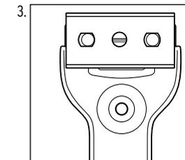
Horní část krytu opět nasadíte a šroub zasroubujete.
