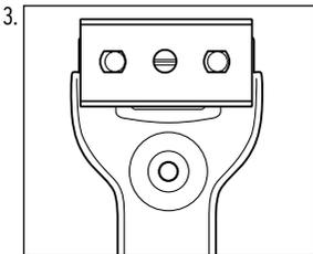
Setzen Sie das Gehäuse-oberteil wieder auf und drehen Sie die Schraube hinein.
